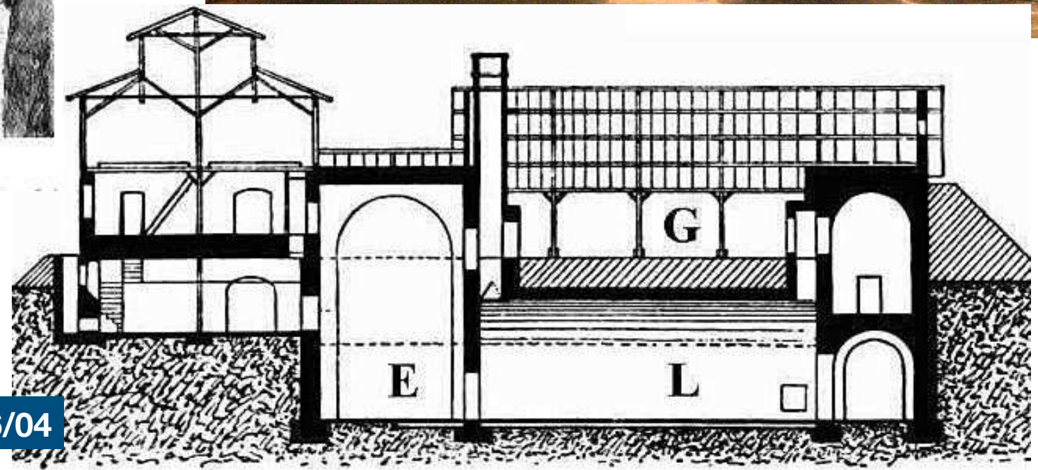
Querschnitt durch eine Brauerei mit Eis- (E), Gär- (G) und Lagerkeller (L)
